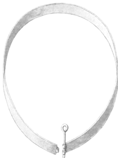
Abb. 1. Blechring zum Guß der Gipsgrundplatte.
